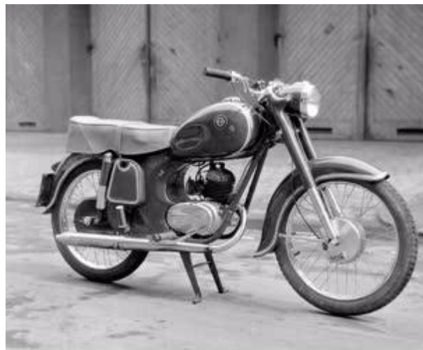
Danuvia DV 125 – Budapesten, a zuglói Danuvia Szerszámgépgyárban 1957-66 között gyártott motor-kerékpár-típus neve. Utazósebessége kb. 70 km/ó.
